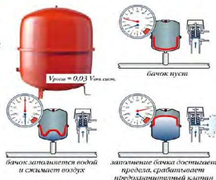
2. проверить наличие предохранительного клапана на расширительном сосуде закрытого типа; проверить исправность предохранительных клапанов, манометров, термометров установленных на оборудовании;
