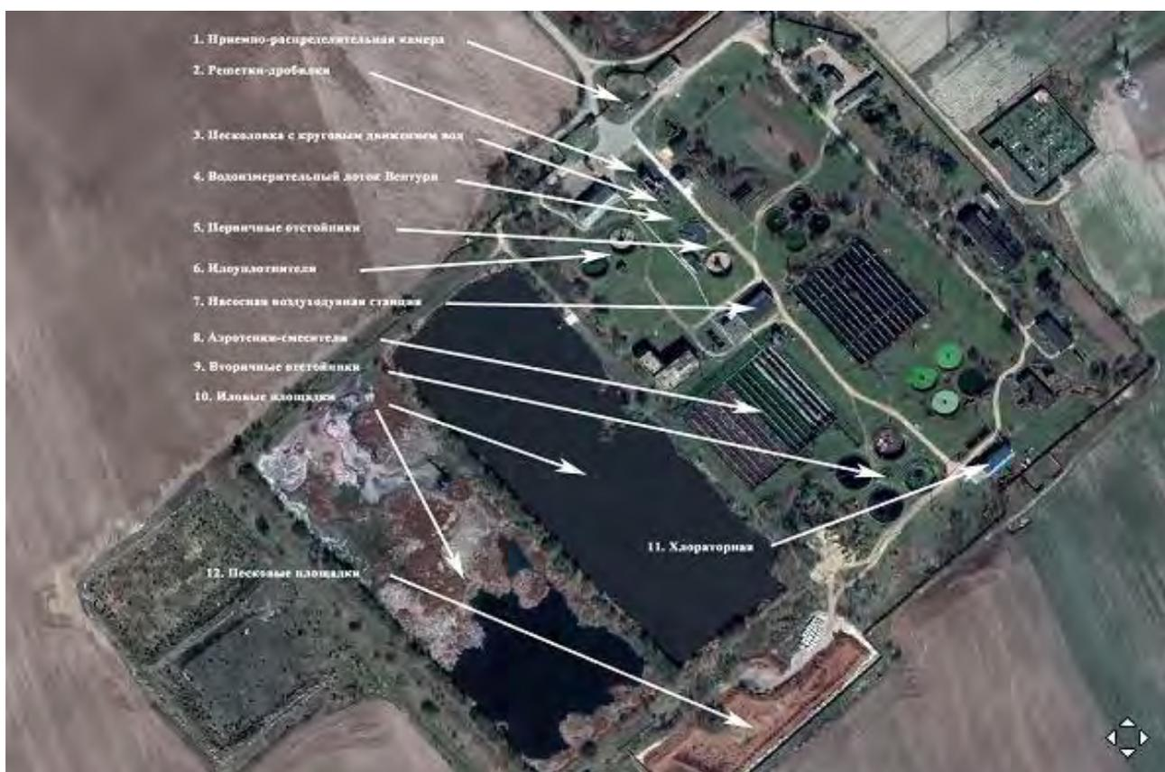
Рис. 4. Яндекс-схема расположения основных зданий и сооружений существующих очистных сооружений
